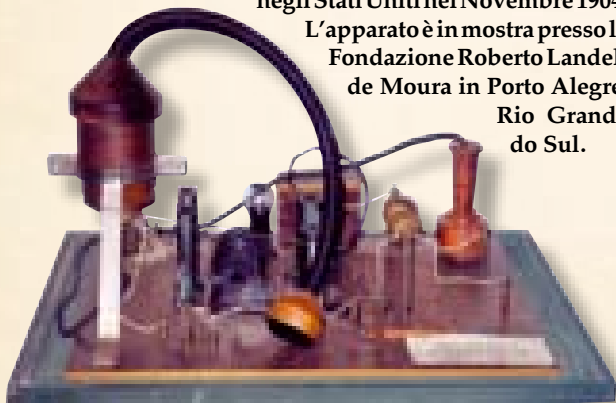
Fig. 2 – Riproduzione del trasmettitore d’onde di Landell de Moura. Per questa invenzione gli vennero concessi i brevetti rispettivamente 3279 in Brasile nel settembre del 1901, e 771.917 negli Stati Uniti nel Novembre 1904.
